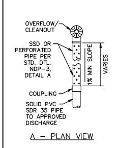
PIPE W/ UNDERDRAIN & DISCHARGE POINT
