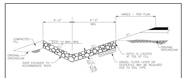
ROCK-LINED SHOULDER DITCH IN FILL SECTION
