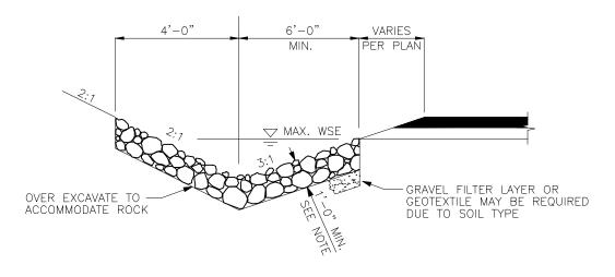
ROCK-LINED SHOULDER DITCH IN CUT SECTION
