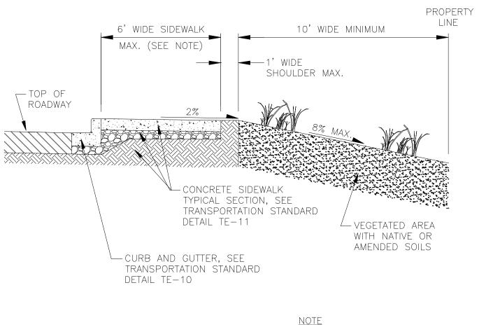
NOTE LONGITUDINAL SLOPE SHALL BE 10% MAXIMUM
